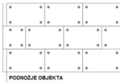
4 pričvrstnice/ploča ili 6 kom/m 2 fasade
