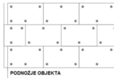
5 pričvrstnica/ploča ili 8 kom/m 2 fasade
