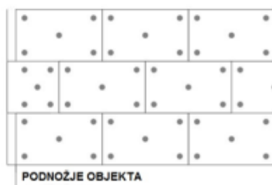
5 pričvrstnica/ploča ili 8 kom/m 2 fasade
